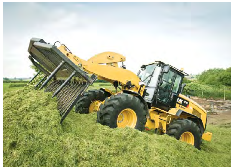
Фронтальний навантажувач Cat 924K зі складаними вилами для перевантаження силосу
