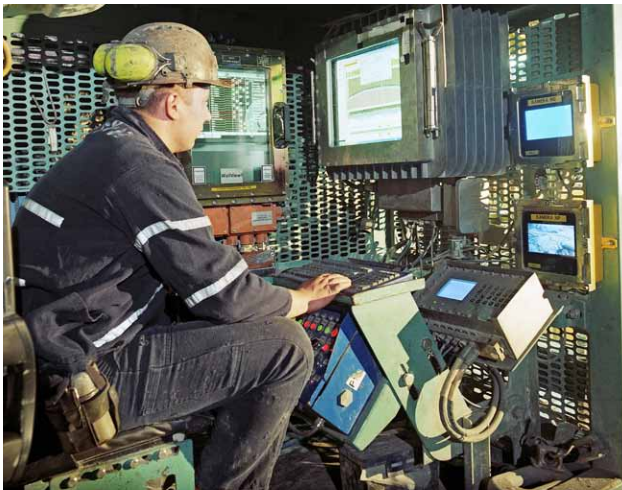
Подземная кабина управления и контроля процесса струговой выемки
