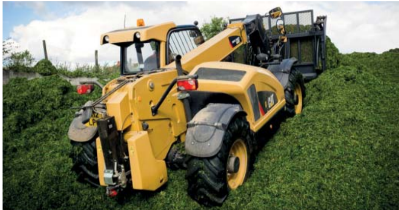
Телескопічний навантажувач TH 407C, навісне обладнання — вили
