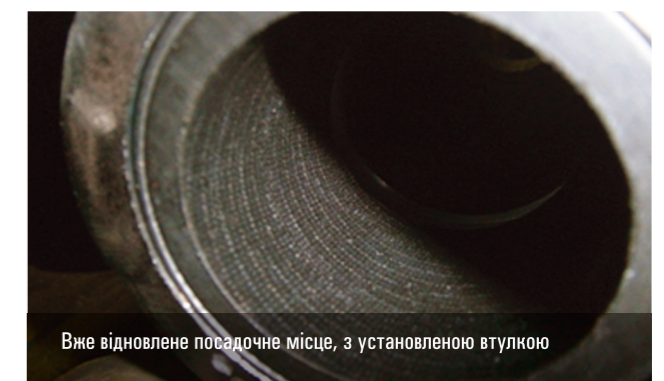
Розточка наплавленого місця до розмірів, необхідних для установки втулки чи, безпосередньо, під розмір пальця
