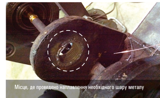
Розточка наплавленого місця до розмірів, необхідних для установки втулки чи, безпосередньо, під розмір пальця
